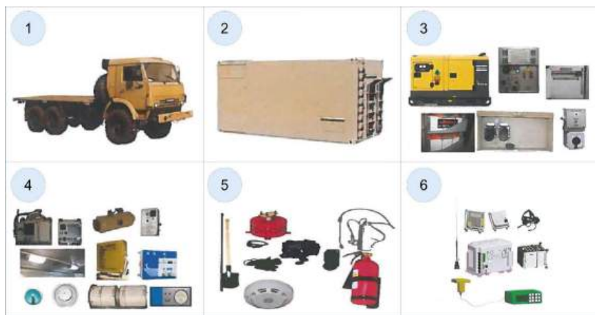
Рис. 2.1. Оборудование общего назначения [11, с. 60]: 1 — шасси КамАЗ; 2 — кузов-контейнер; 3 — СЭП; 4 — СОЖ; 5 — вспомогательное оборудование; 6 — средства связи и навигации
